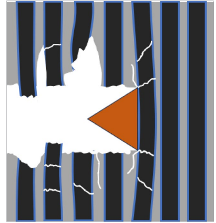
图17 垂直方向材料去除机制分析示意图
